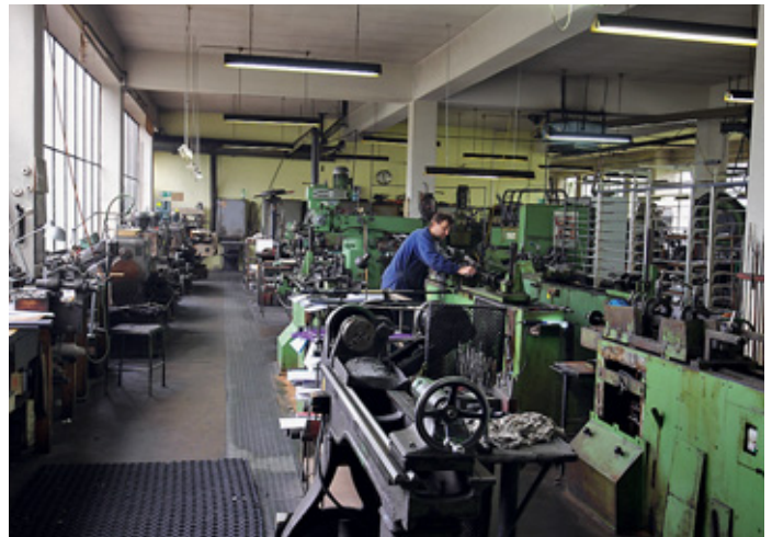
Вид на ствольный участок фабрики FMF. Во время моего визита стволов на резании не было, тогда как ковальная машина была загружена на весь день
