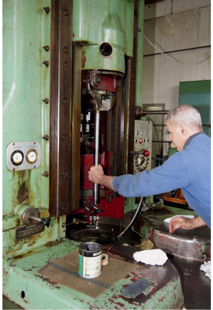
На видавшей виды вертикально-ковочной машине изготавливают стволы большинства стандартных калибров. На стеллажах я видел готовые болванки примерно 30 калибров, некоторые из которых в количестве нескольких десятков штук. Стволы куются с предварительной развёрткой и хонингованием на малой скорости и с удлинением всего на 10-15%
